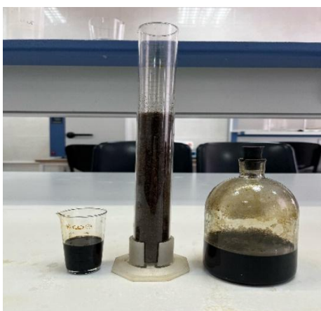
Рисунок 1. Определение скорости проникновения нефти в образце
