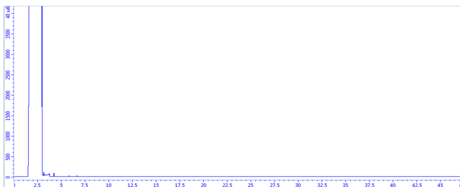
Рис. 3. Хроматограмма экстракта земли после 2 часов внесения нефти
