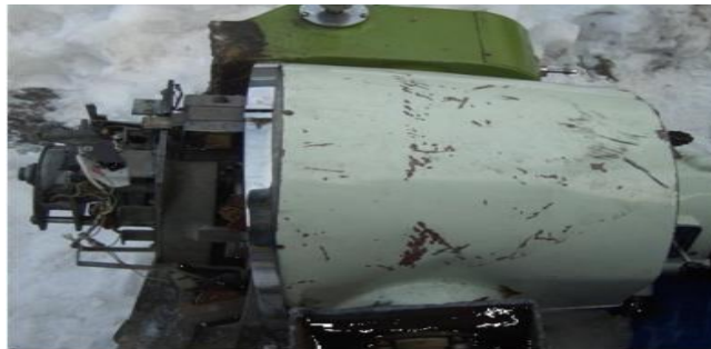
Qamma-terapevtik cihaz LUCH-1 (tərkibində tükənmiş uranın yarım tonları var, daxilində kobalt-60)
