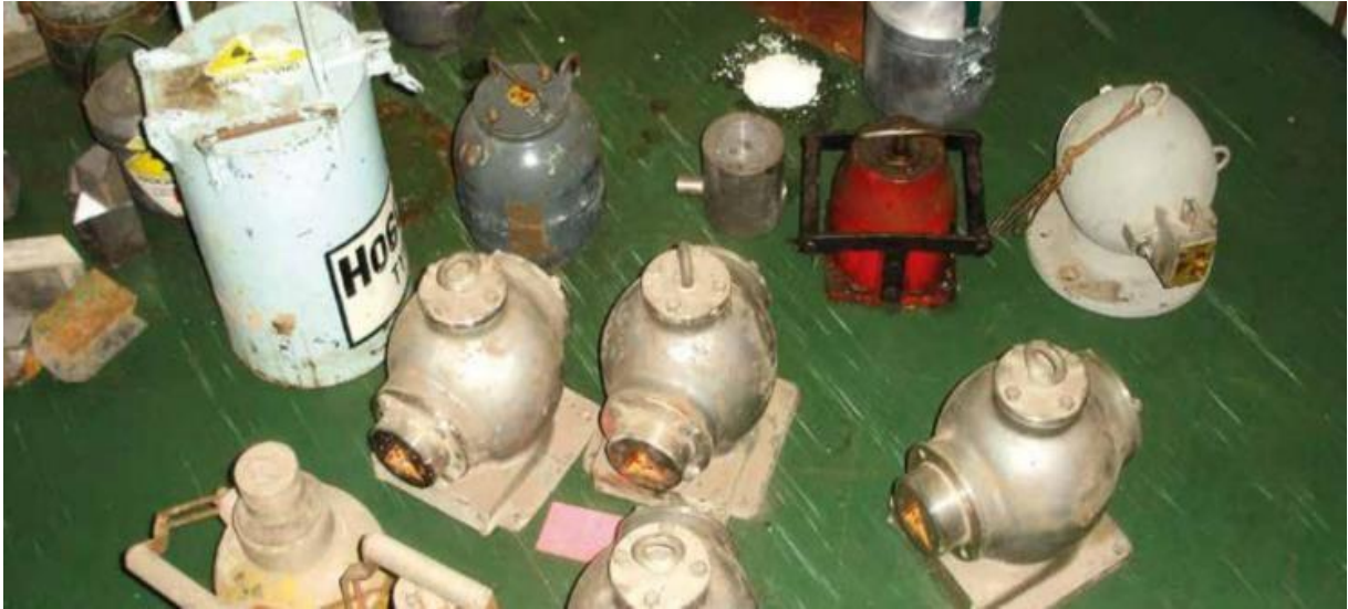
Şəkil. Sahibsiz radioaktiv mənbələr
