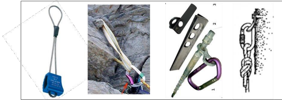
Şəkil 1. bərkitmə nöqtələrində istifadə olunan bərkidici vasitələr
