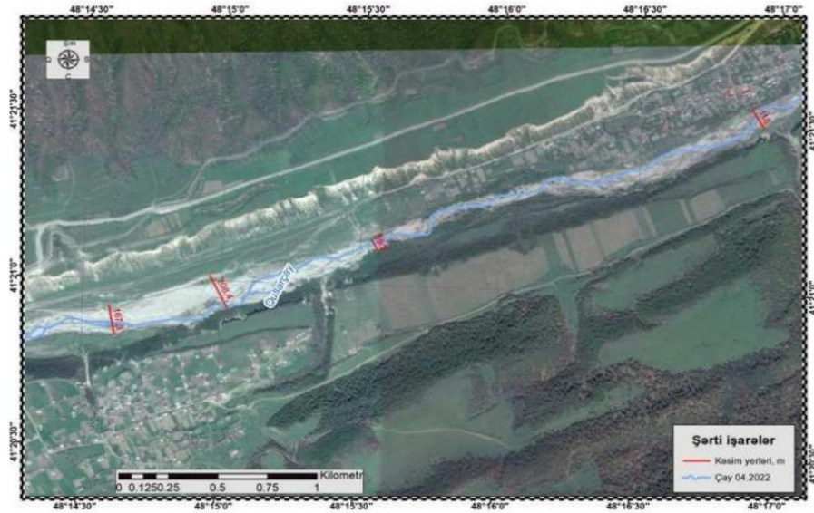
Şəkil 5. Zəyəmçayda yaz fəslində məcrə deformasiyaları
