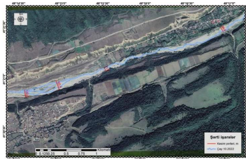
Şəkil 7. Zəyəmçayda payız fəslində məcrə deformasiyaları
