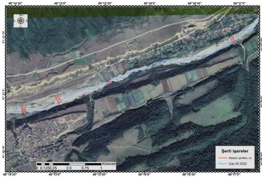
Şəkil 4. Zəyəmçayda qış fəslində məcrə deformasiyaları
